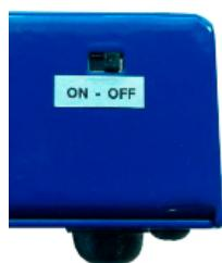
Mediante un interruptor puesto en la parte trasera (sobre el lado del conector 25 PIN) es posible deshabilitar el conmutador.
