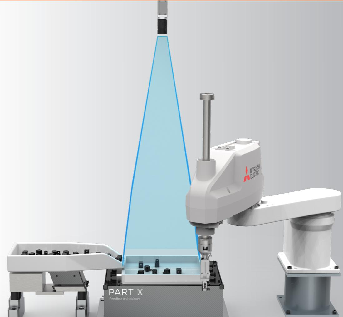
La vibrazione della PartX separa e orienta i componenti per il prelievo del robot. Una telecamera con software di visione localizza i componenti correttamente orientati e invia le coordinate al robot. Il sistema di visione rileva anche e regola il numero all'interno dell'alimentatore flessibile.
