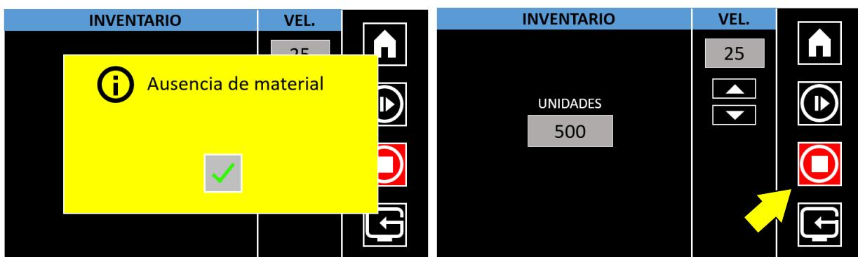
Para volver a iniciar el contaje se quitará el mensaje de aviso pulsando el botón de *Visto*. Luego si se desea empezar el contaje desde cero se tendrá que resetear el contador pulsando el botón de *Reseteo de contaje*.
