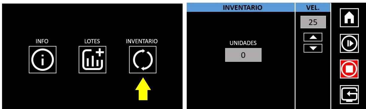
Una vez en la pantalla de *Inventario* se podrá iniciar el conteo pulsando el botón de *Marcha*. La velocidad del vibrador es regulable mediante los botones de *Subir/Bajar velocidad*.
